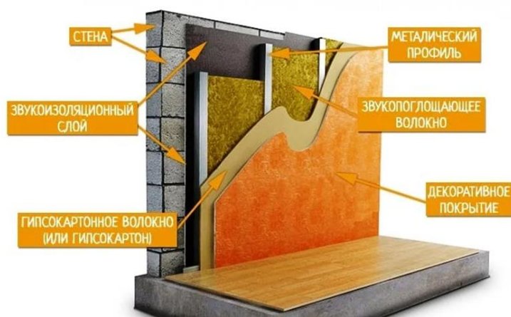
Рисунок 4. Пример звукоизоляции ограждающей конструкции
