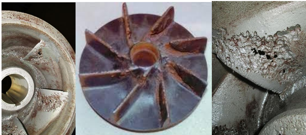
Рисунок 2. Проявление кавитации на рабочих колёсах (Интернет-издания*).
